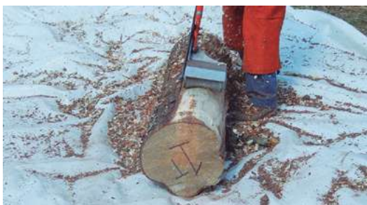
Figura 178. Descortezadora adaptada a la espada de la motosierra. (Fotografía: S. A. Quiñonez)
