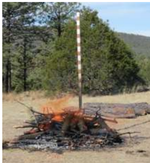
Figura 183. Proceso de quema y altura de flama en hogueras de dos tamaños. (Fotografías: S. A. Quiñonez)
