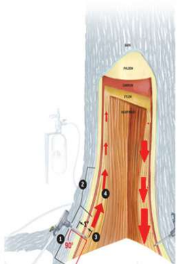
Figura 207. Esquema de movimiento ascendente y descendente del producto inyectado. (Imagen: arborjet.com)
