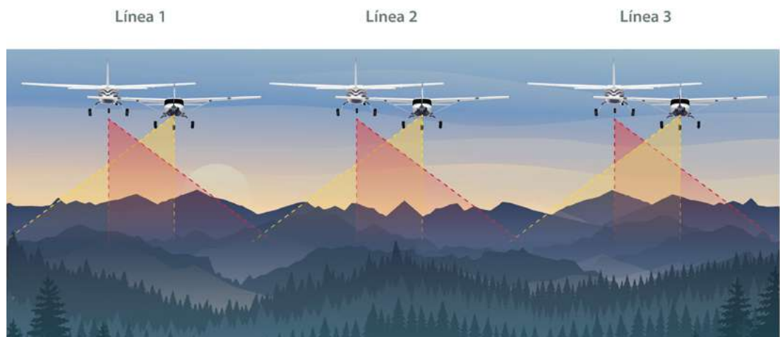
Figura 123. Vuelo en paralelo con un observador. (Ilustración: E. Llanderal)
