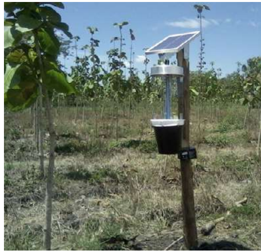
Figura 112. Trampa automatizada de luz ultravioleta para la captura de insectos defoliadores nocturnos. (Fotografía: V. D. Cibrián)
