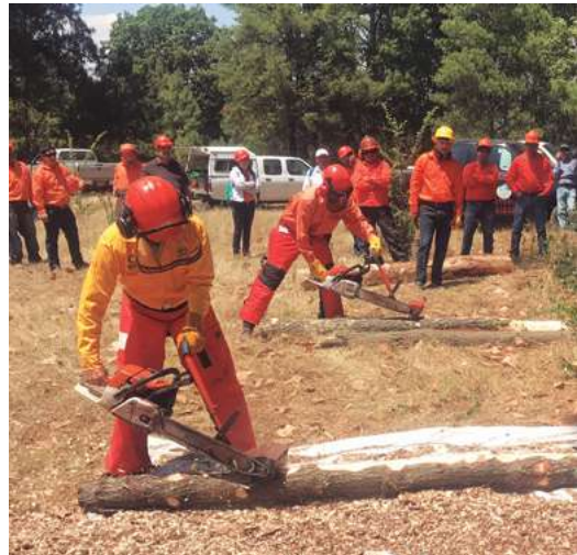
Figura 177. Descortezadora acoplada a la espada de la motosierra. El tambor y las cuchillas curvas se adaptan a la curvatura de los troncos infestados.
