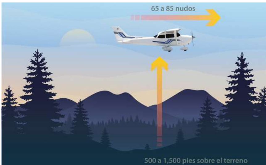
Figura 129. Altitud entre 500 y 1,500 pies y velocidad de vuelo 65 a 85 nudos. (Ilustración: E. Llanderal)
