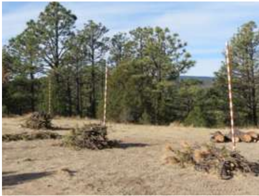
Figura 182. Preparación de hogueras para medir altura de flama, temperatura y efectividad de muerte de insectos descortezadores. (Fotografía: S. A. Quiñonez)
