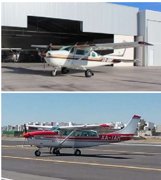
Figura 119. Arriba, avión Cessna 206. Abajo, avión Cessna 207 de mayor tamaño, permite llevar más de dos evaluadores a bordo. Apropriados para el mapeo aéreo por tener ala alta.
